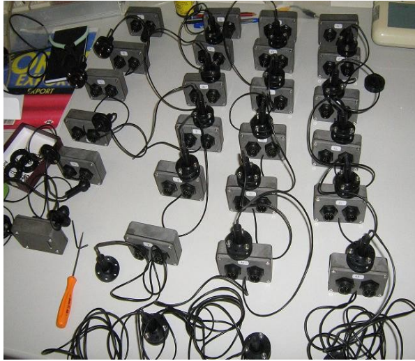
Figura 4: Un sistema costituito da 24 sensori lineari.
