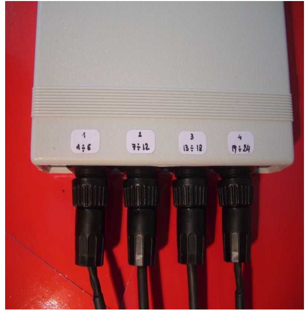
Figura 5: Un HUB utilizzato per il collegamento dei sensori lineari al PC master.
