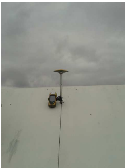
Figura 1 ancoraggio dei ricevitori GNSS alla parabola di SRT
