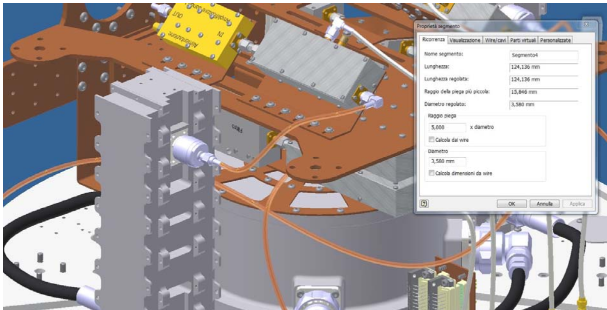
Figura 14: Tratto di cavo in rame che va dall'ibrido in guida d'onda all'accoppiatore in microstriscia.
