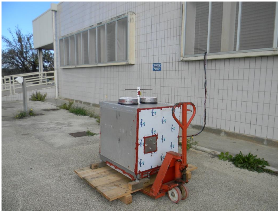
Figura 31 Assemblaggio del nuovo ricevitore PLSX che durante il periodo della campagna di misure si trovava davanti alla finestra del laboratorio della stazione. Il segnale a 8080 MHz emesso da un oscillatore locale interno era trasmesso all'esterno probabilmente attraverso uno dei feed posti sulla parte superiore della scatola.
