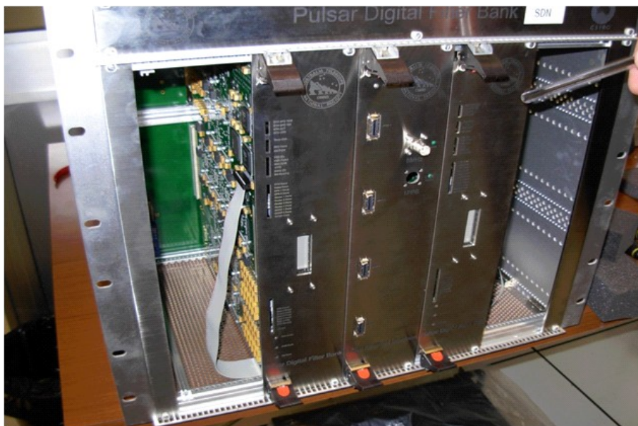
Figura 18: PDFB dopo il montaggio delle schede CAB1, CAB2 e COM
