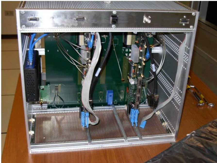
Figura 20: Lato posteriore del cestello dopo il montaggio delle schede RTM1 e RTM2
