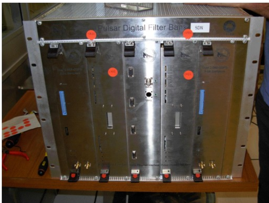
Figura 21: Lato anteriore del PDFB completo
