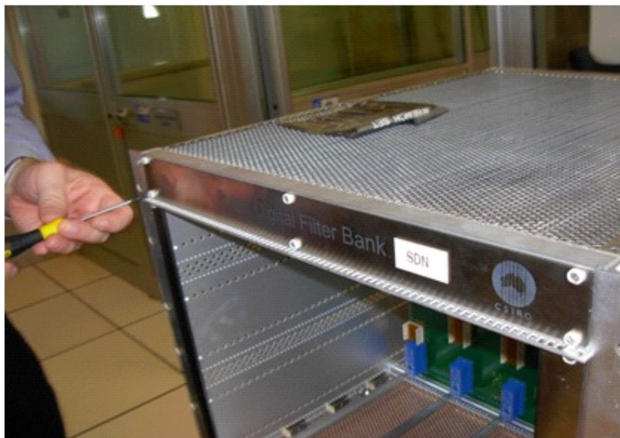
Figura 7: Smontaggio del pannellino del cesto
