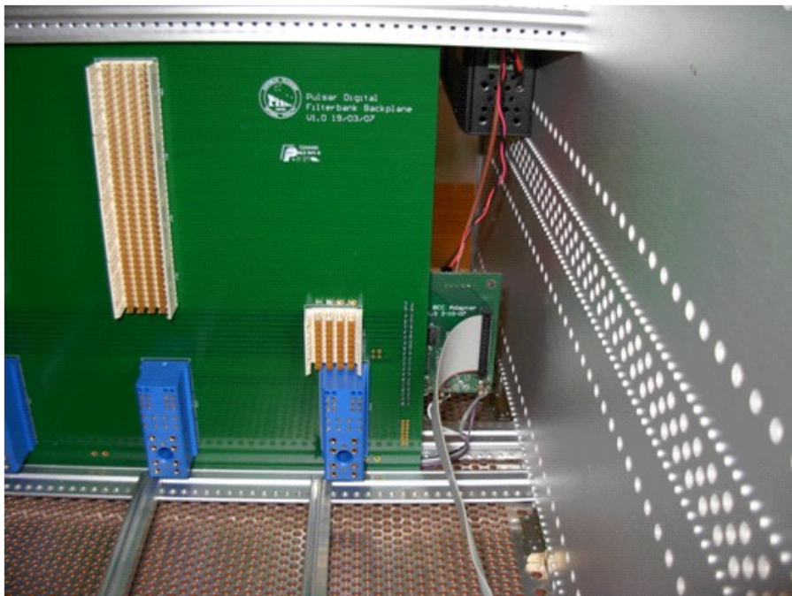
Figura 10: Estremo del cavo flat collegato al backplane
