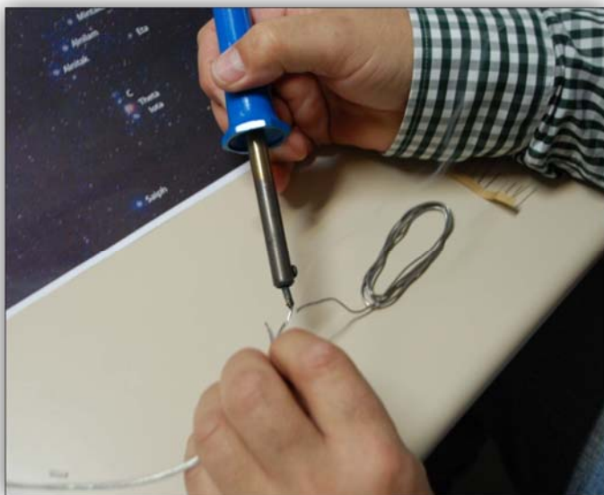
Fig. 6. Saldatura dei collegamenti elettrici
