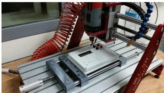
Figura 25: Lavorazione del coperchio e dettaglio del coperchio
