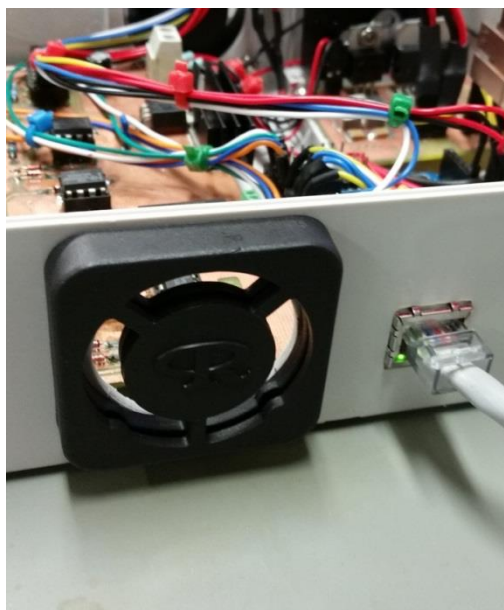
Figura 26: Dettaglio foro di ingresso e uscita dell'aria
