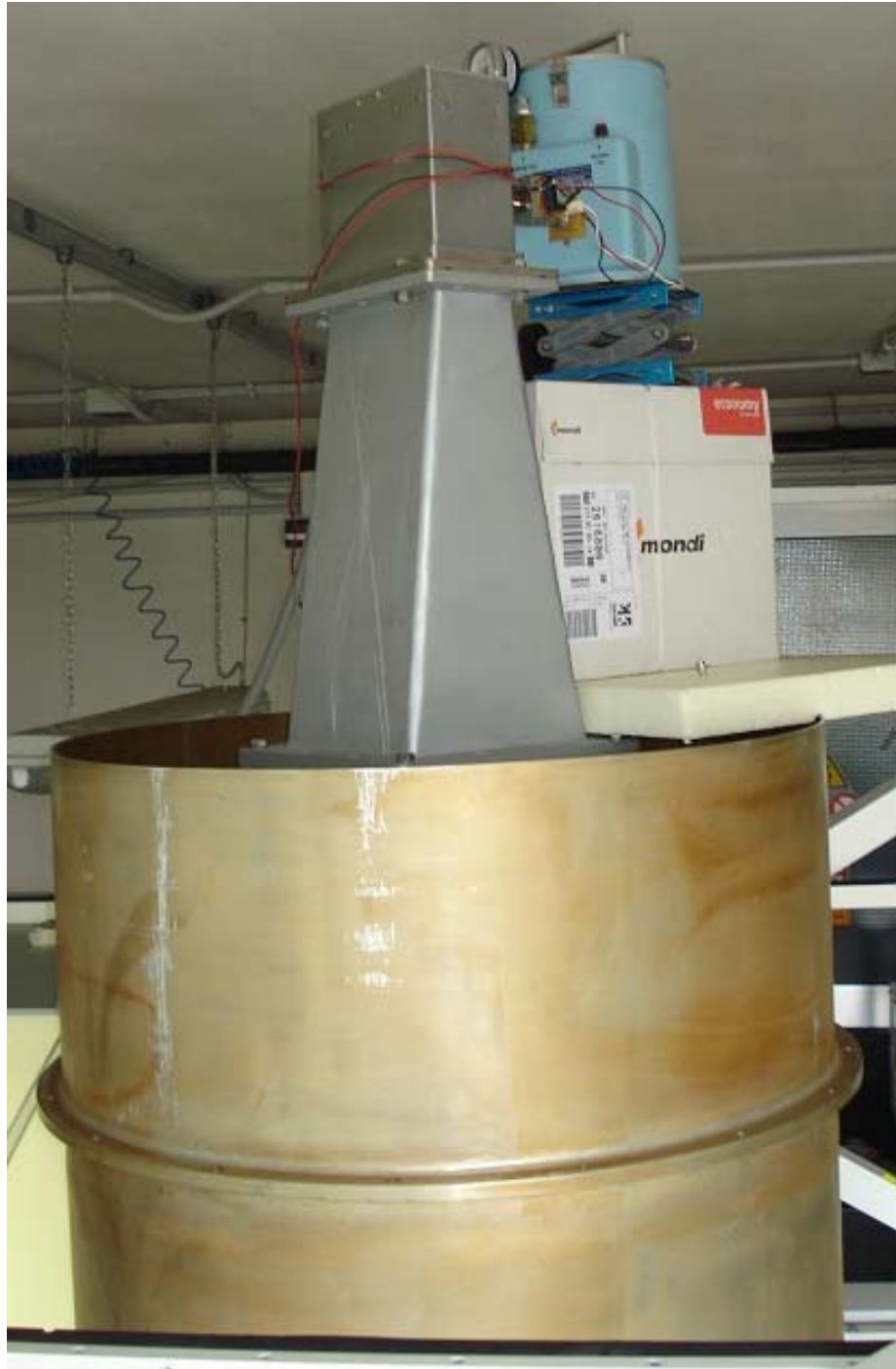
Fig.8 Setup di misura del banda L. Nel dettaglio il collegamento del carico della Maury alla guida d'onda per l'iniezione del carico caldo e del carico freddo.
