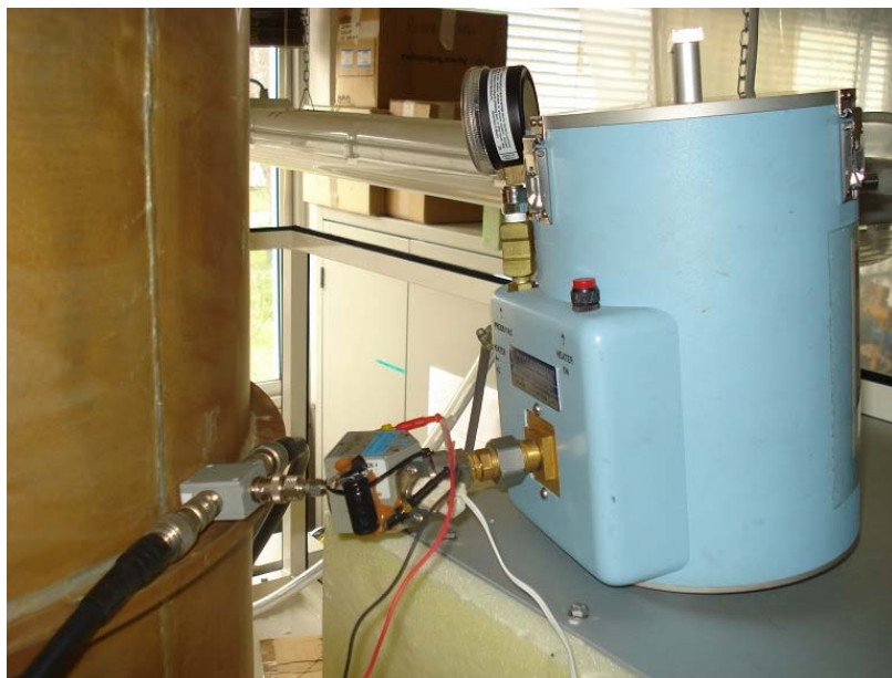
Fig.6 Setup di misura del banda P, nel dettaglio il collegamento del carico della Maury allo splitter che divide e sfasa di 180° il carico caldo e freddo.
